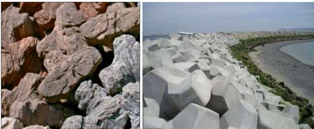
Figure 2-4 : à gauche : illustrations des blocs de béton – Ecopodes<sup>TM</sup> (exemple de texture et coloration). A droite : illustration des blocs de béton lisse – Accropodes<sup>TM</sup>.
