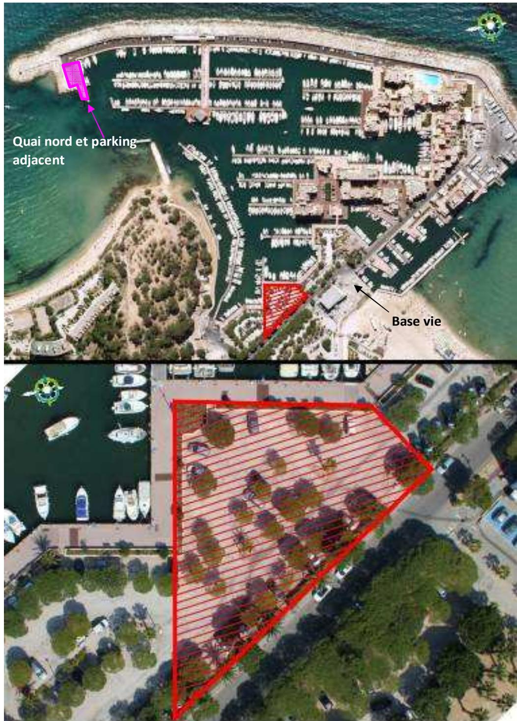
Figure 15 : emplacement de l'aire de stationnement des matériels sur le quai nord, de l'aire de tri / stockage et de la base vie.
