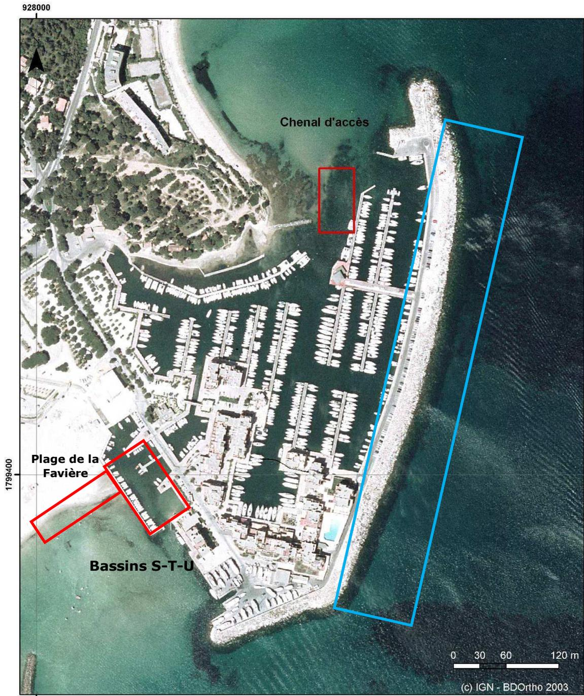
Figure 84 : localisation des zones du port de Bormes faisant l'objet de dragage d'entretien et zone du projet de reconception et reconstruction de la digue du large.
