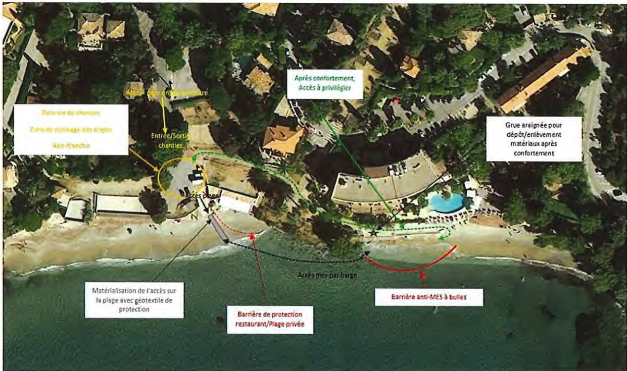
Figure 9 : Installations de chantier et méthodologie d'intervention.
