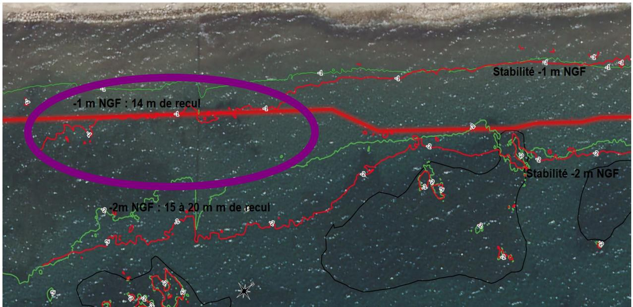
Figure 7 : Comparaison des données bathymétriques 2010 – 2020
