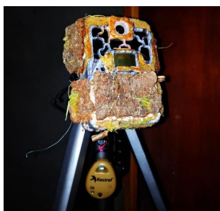
Figure 1 – Piège photo et datalogger hygro-thermique
