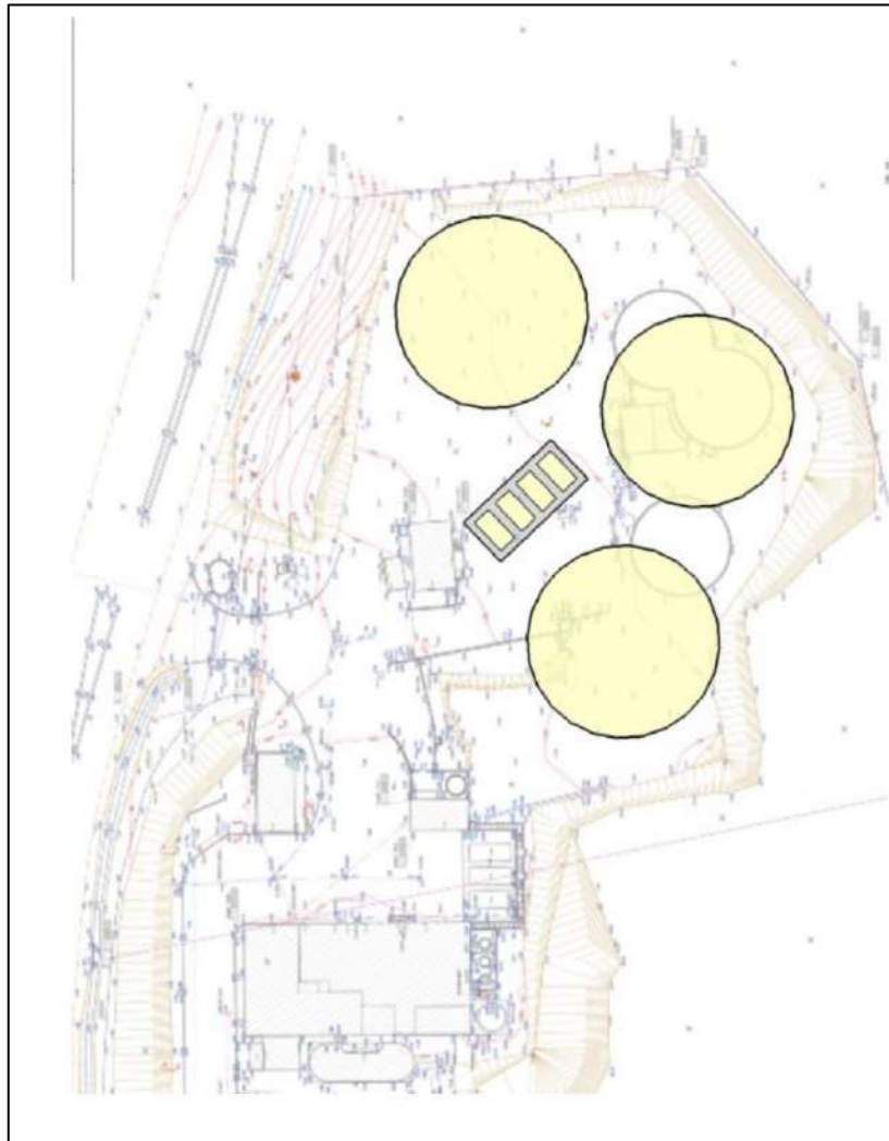
Figure 17 : Localisation de l'implantation des clarificateurs et des filtres mécaniques dans le cas de la solution n°1 (Source : BEEE)
