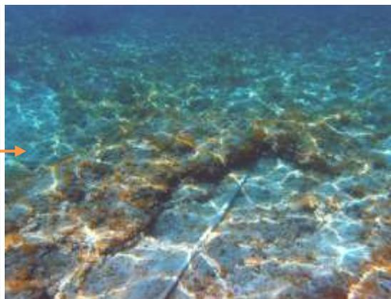
Une gaine plastique contenant un fil de cuivre de diamètre 0,5 à 1 cm est présente à moins de 2 mètres du bord et à 1,20 mètres de profondeur. Il semble s'agir de la partie n°2 du câble FRANCE ALGERIE 4 qui a perdu totalement son enveloppe protectrice. Elle est posée sur un fond rocheux.
