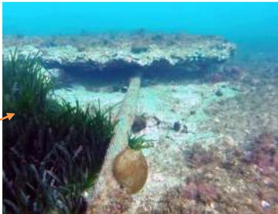
Le câble AMITIE s'est glissé sous une dalle rocheuse plate qui le recouvre sur 1 mètre de longueur.
