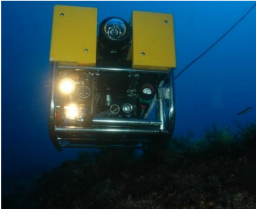
Figure 7. Le ROV SUPER ACHILLE en opération (source : COMEX).
