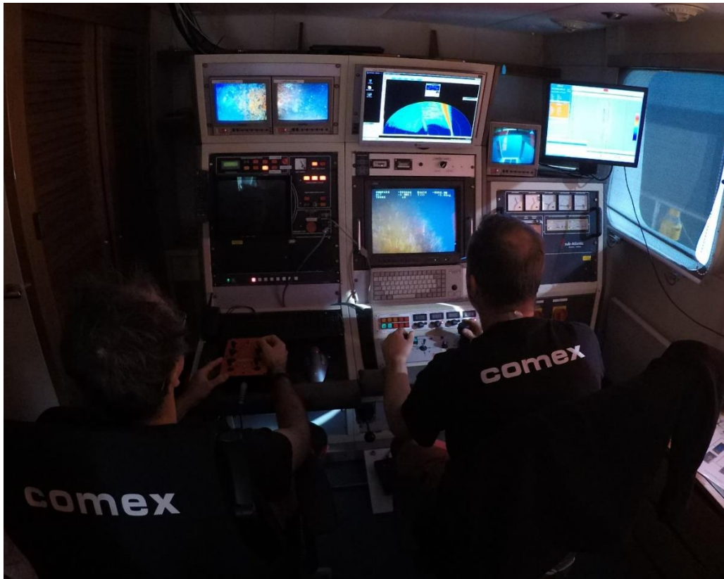
Figure 6. Poste de pilotage et de contrôle du ROV Apache (source : COMEX).
