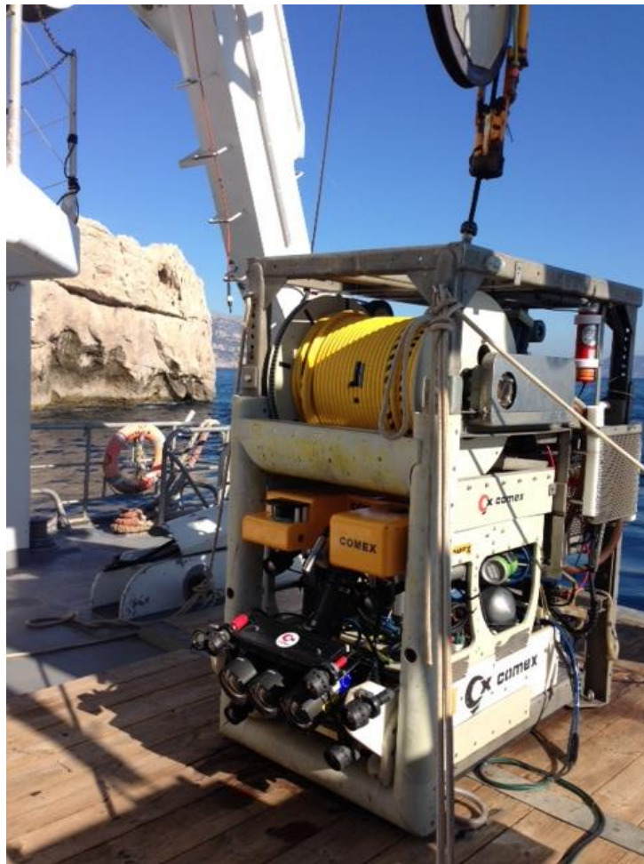
Figure 4. Le ROV Apache dans sa cage (TMS) munis du système ORUS3D (source : COMEX).
