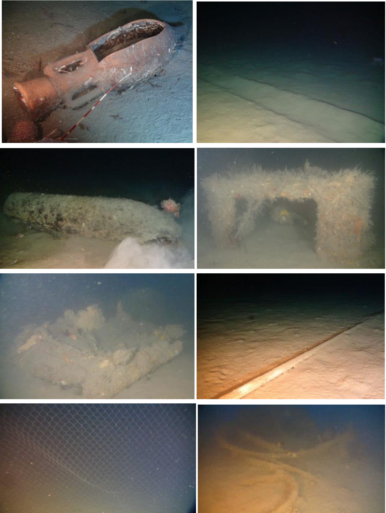
Figure 32: Photos de diverses obstructions observées lors de la campagne ROV pour les câbles M2 et M3, de gauche à droite : en haut, amphore antique, traces de chalut dans le canyon ; à la seconde ligne, missile non explosé (ou UXO), morceau d'épave de bateau ; à la troisième ligne, épave de voiture, câble posé au fond ; en bas, filet de pêche actif, amas de câbles (setec in vivo, 2020)
