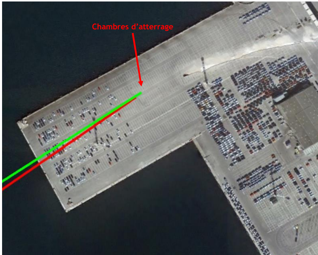
Figure 5 : Vue plus précise de la zone d'atterrage des câbles M2 et M3
