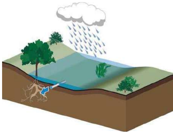
Noue perpendiculaire à la pente le long des cheminements
