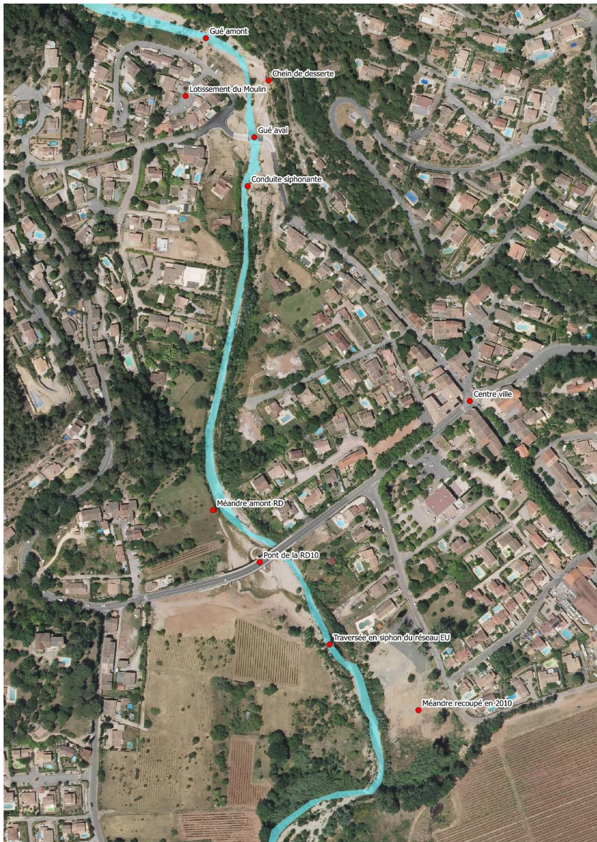
Figure 1 : Localisation des principaux ouvrages et secteurs d'intervention
