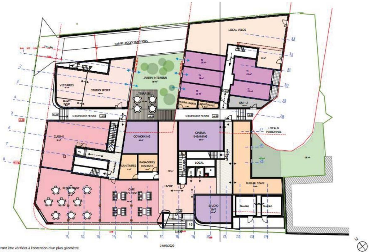
Figure 17 : Plan du RDC provisoire (source : Atelier DP Architecture)
