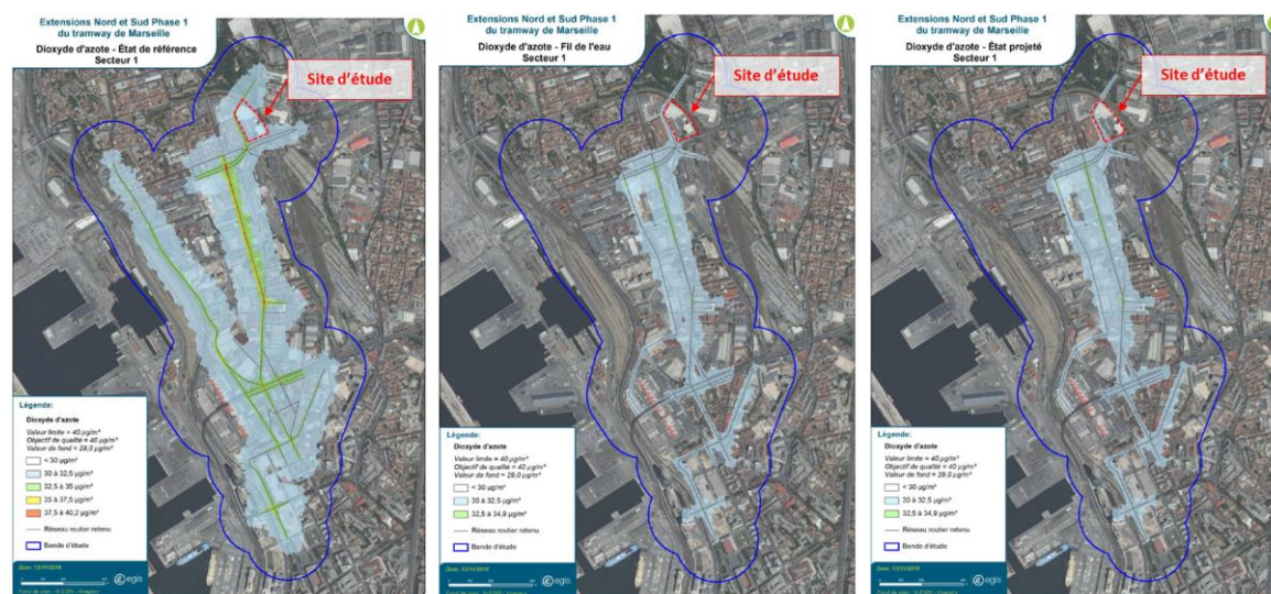
Figure 24 : Comparaison des émissions de 3 polluants calculées entre les 3 scénarios (état de référence à gauche, fil de l'eau au milieu et état projeté à droite) pour le NO 2
