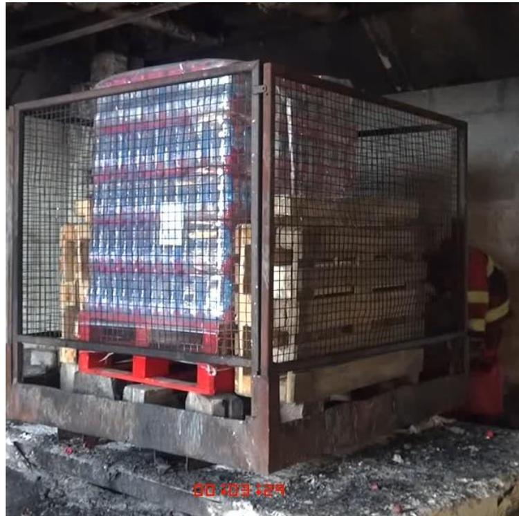
**Figure 5-5 : Principe de disposition des foyers calibrés autour de la palette de bouteilles d'eau – Essai 3**
