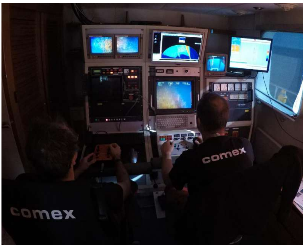
Figure 6. Poste de pilotage et de contrôle du ROV Apache.
