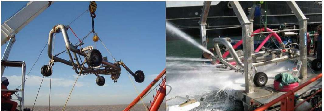
Figure 30 : Trencher de type « jet sledge » permettant l'ensouillage des câbles) (Orange Marine)
