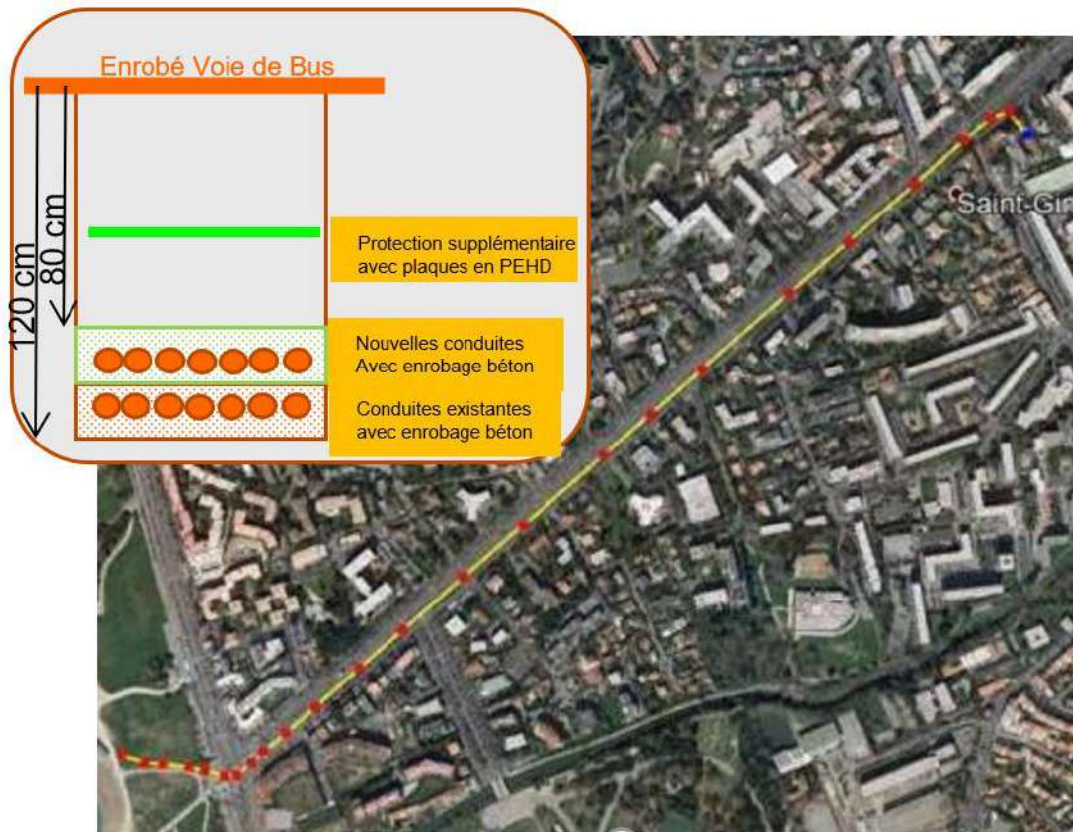
Figure 9 : Localisation du tracé terrestre et vue en coupe de l'installation (source : Orange)
