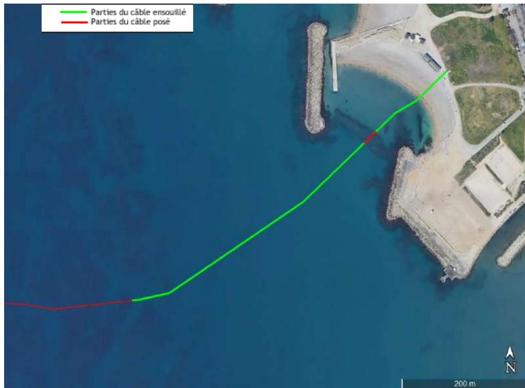
Figure 28 : Zones d'ensouillage du câble
