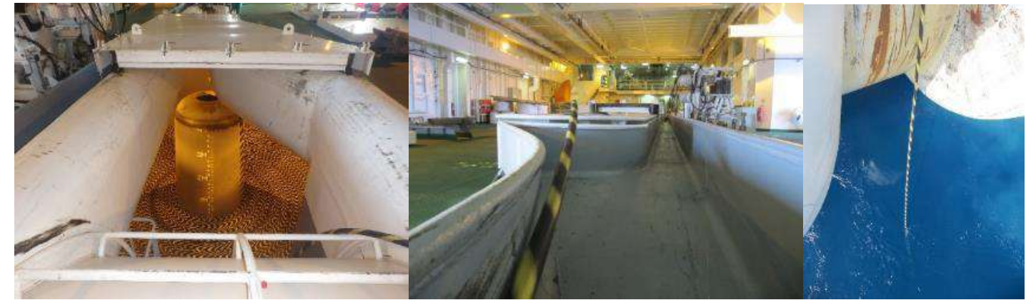
Figure 12 : Déploiement d'un câble depuis la cuve de stockage (photos : setec in vivo ©)
