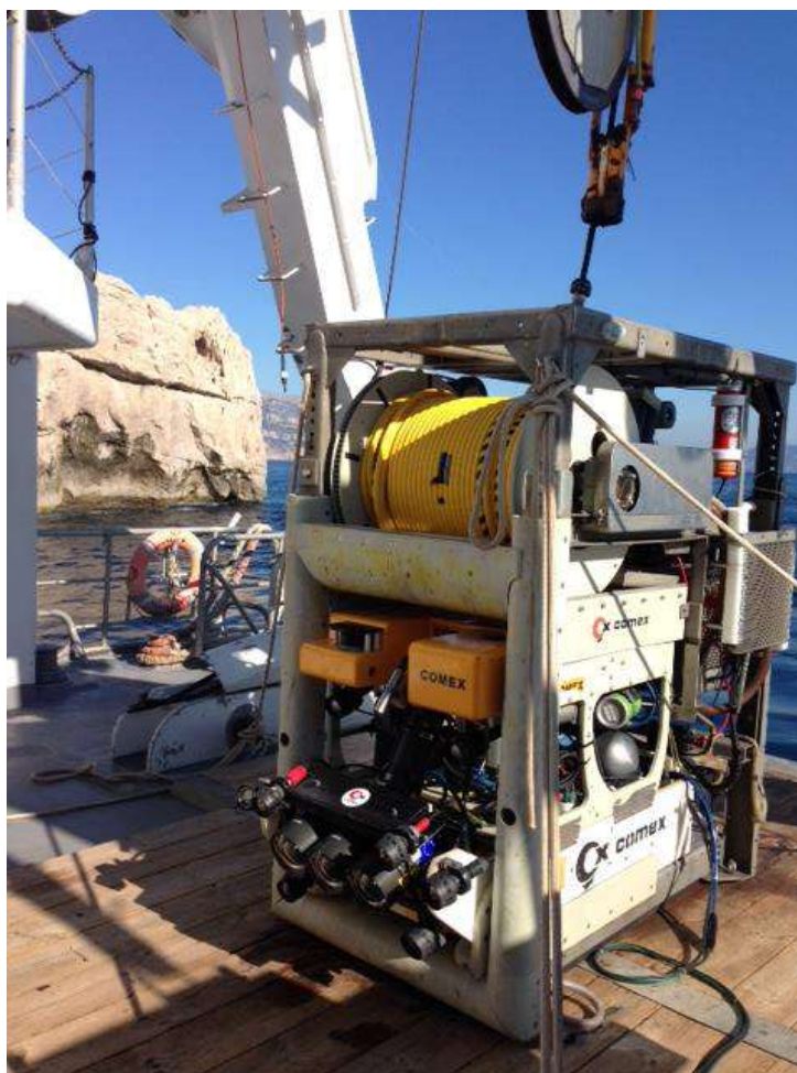
Figure 4. le ROV Apache dans sa cage (TMS) munis du système ORUS3D.
