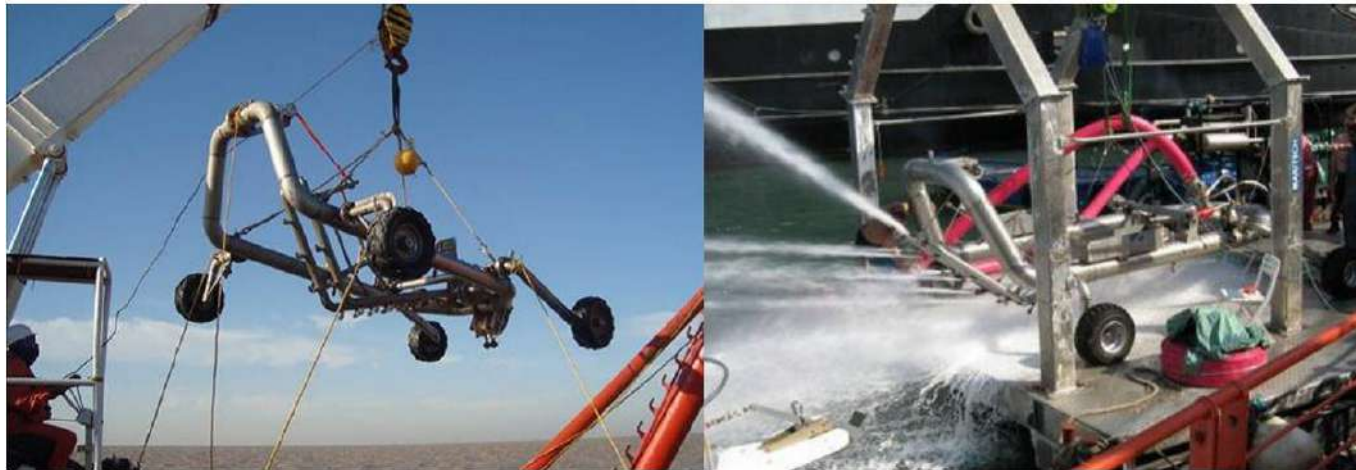
Figure 14 : Trencher de type « jet sledge » permettant l'ensouillage des câbles) (Orange Marine)
