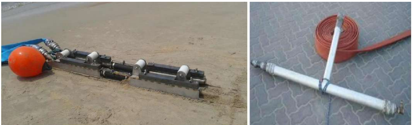
Figure 31 : « Jet sledge » de type WORM pour les eaux très peu profondes (à gauche), lance à eau d'ensouillage (à droite)
