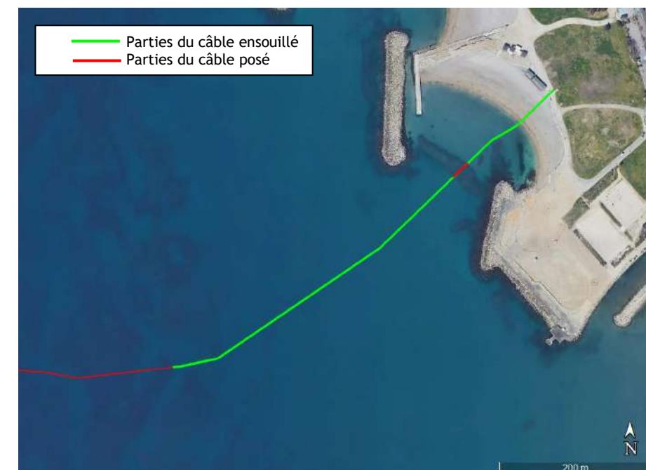
Figure 13 : Zones d'ensouillage du câble du parcours 2
