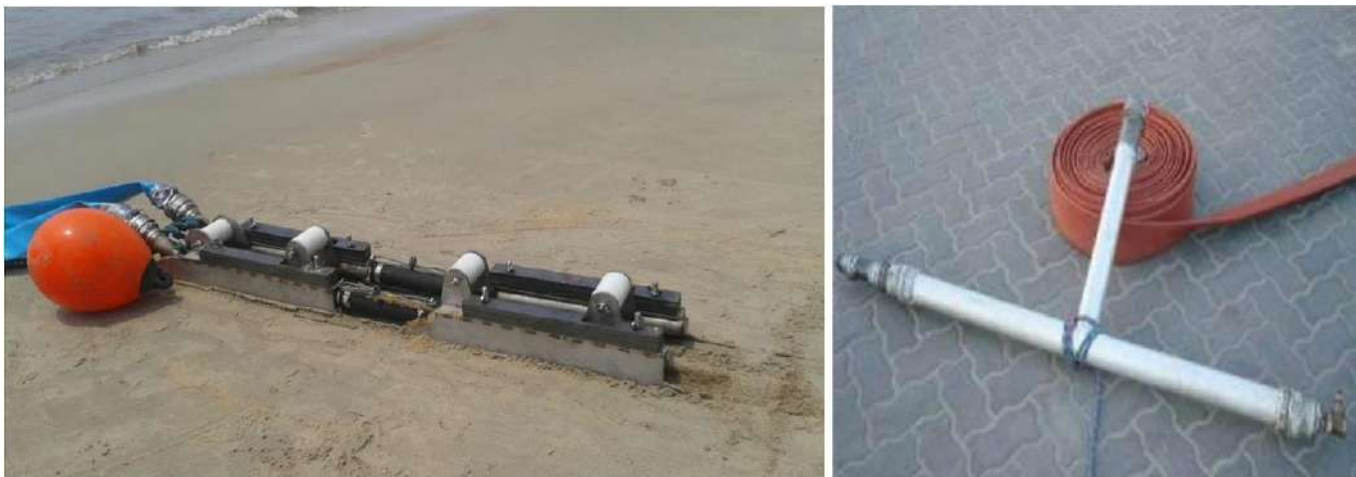
Figure 15 : « Jet sledge » de type WORM pour les eaux très peu profondes (à gauche), lance à eau d'ensouillage (à droite) (source : simec)
