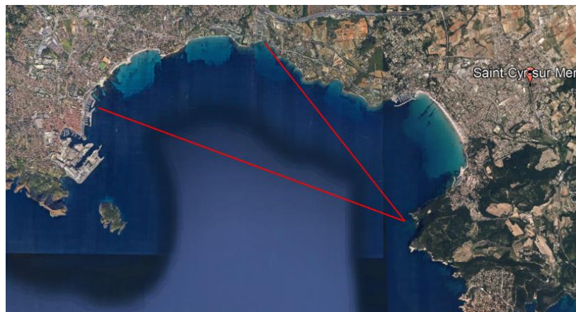
Figure 3 : Secteur d'action du vent local pouvant soulever dans la baie de la Ciotat un clapot significatif au niveau de la conduite.
