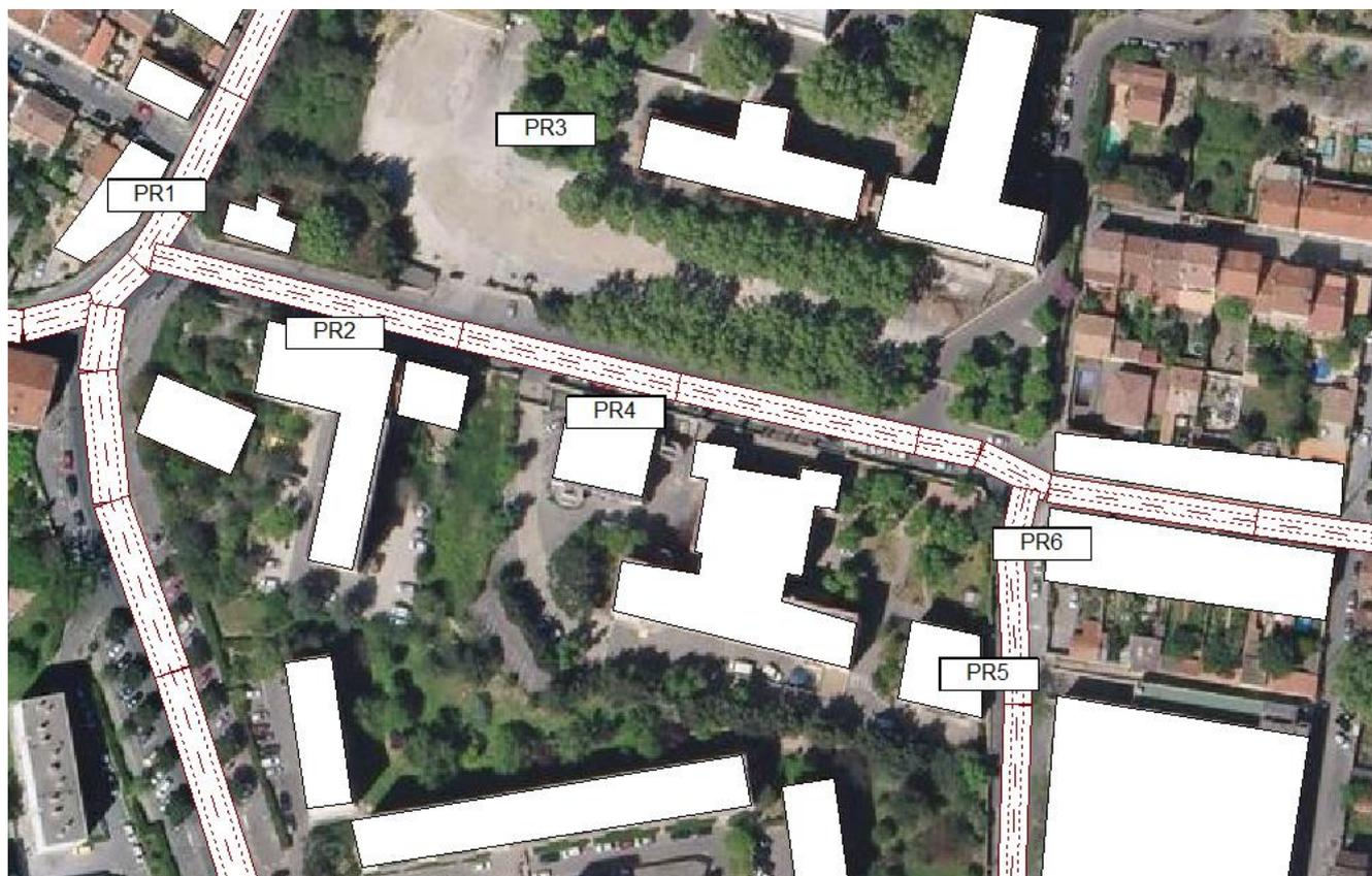
Illustration 8 : Points récepteurs positionnés sur le modèle numérique
