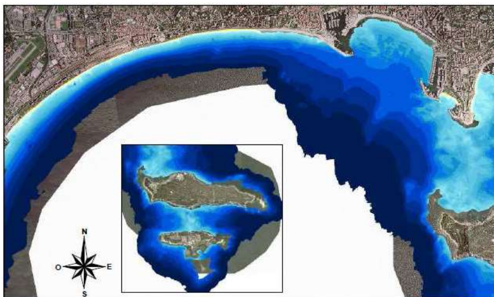
Figure : Levés bathymétriques superposés à l'orthophotographie de 2004 (Sogreah, 2009 Contrat de baie)
