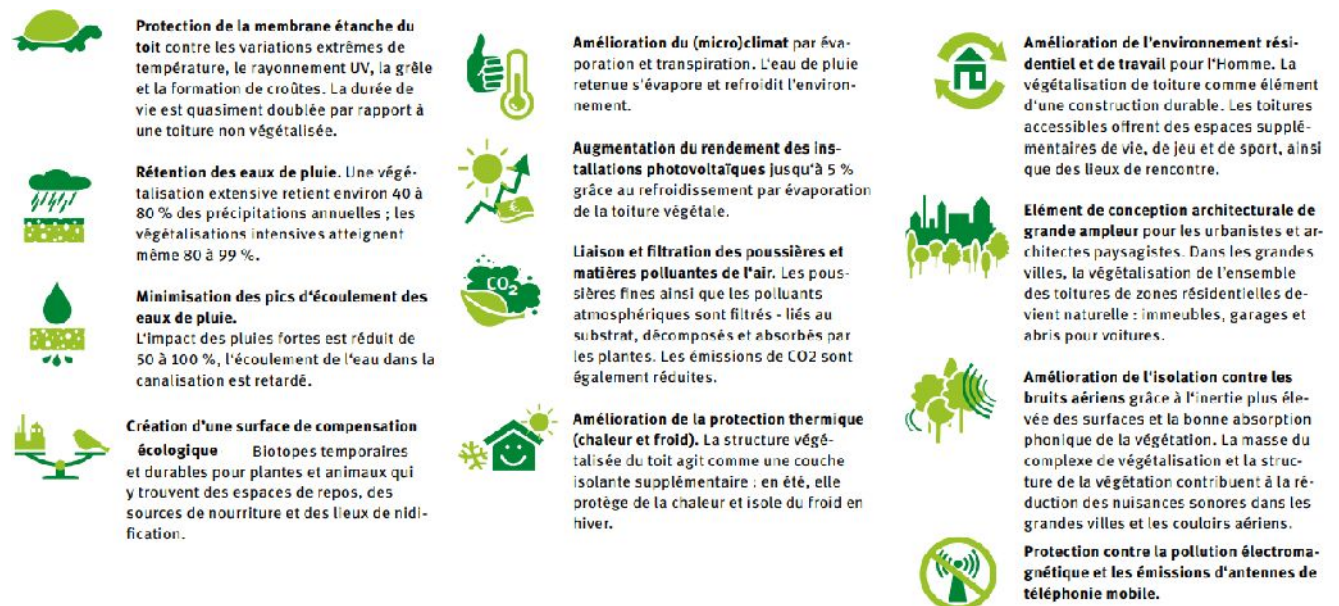
Figure 59 : Avantages des toitures végétalisées (source : Optigreen)
