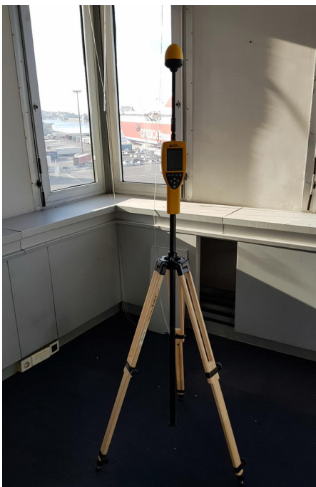
Mesure en large bande – bâtiment existant Le Mirabeau
