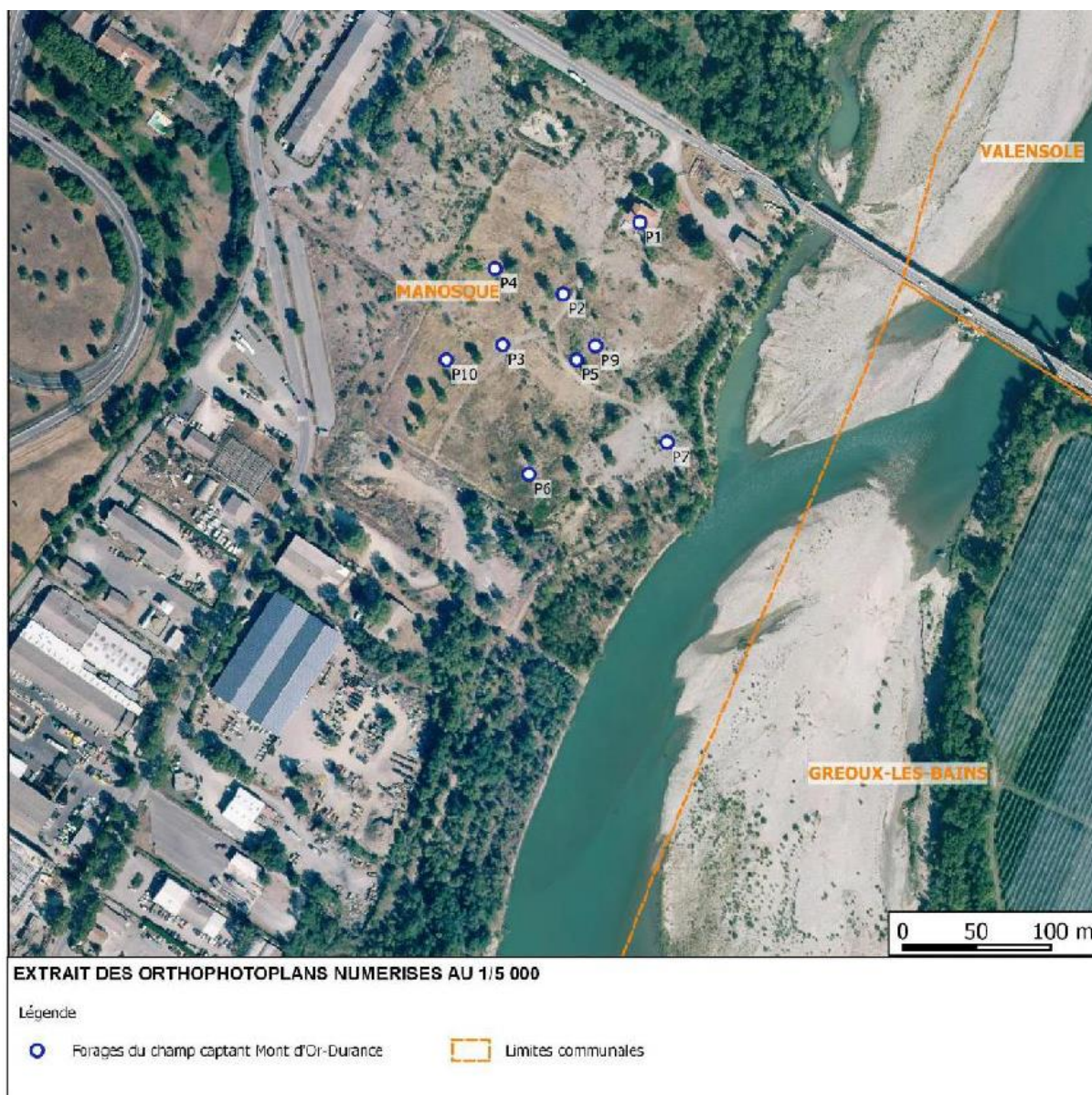
Figure 16 : Localisation des puits du champ captant du Mont d'Or
