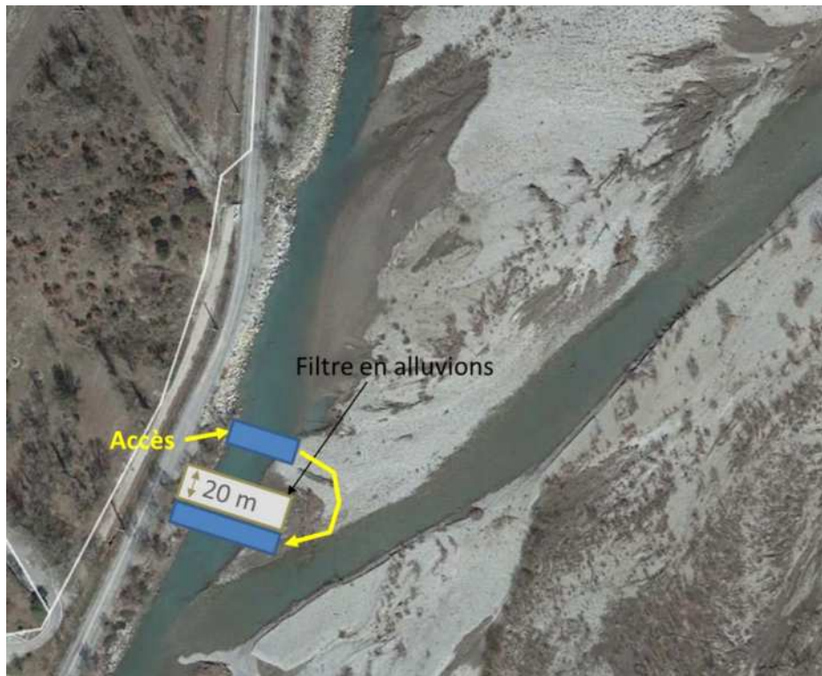
Figure 11 : Schéma du principe de confinement du chantier
