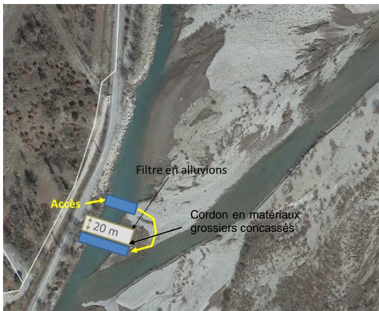
Figure 23 : Schéma du principe de confinement du chantier
