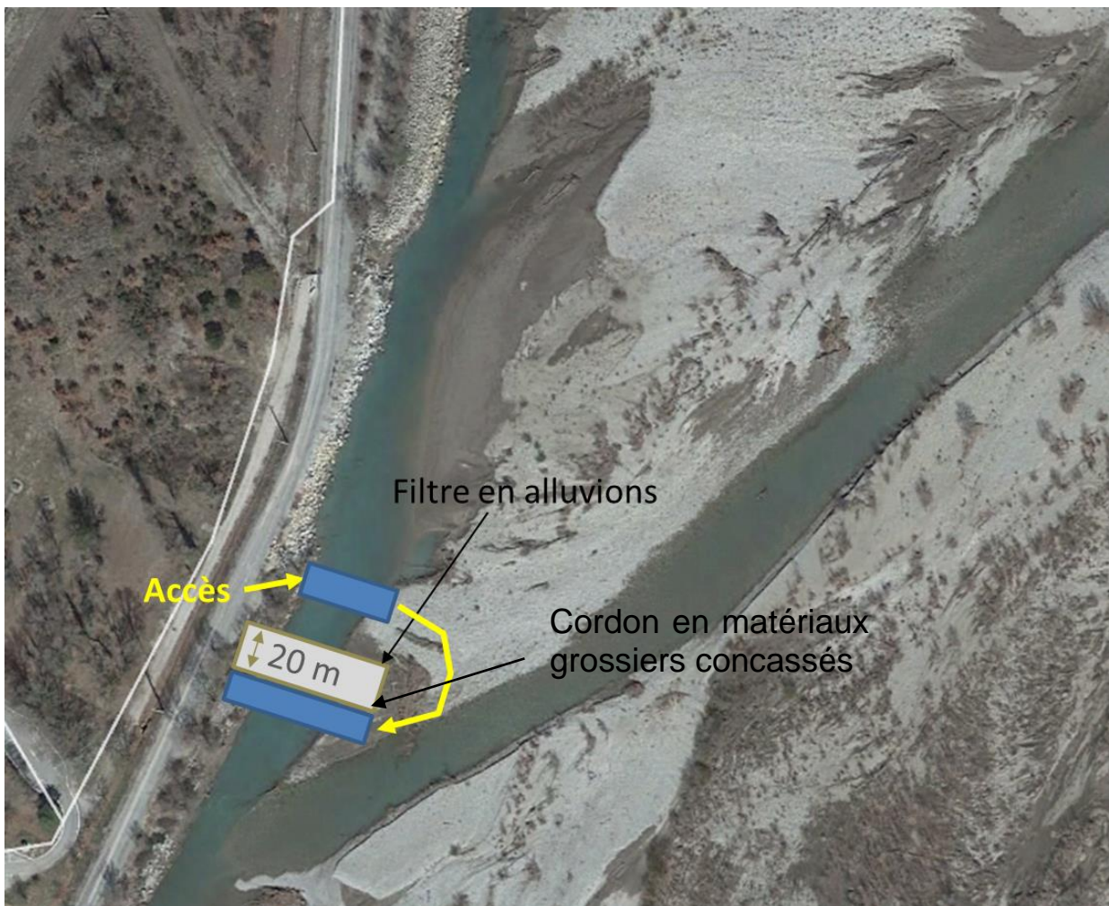
Figure 24 : Schéma du principe de confinement du chantier
