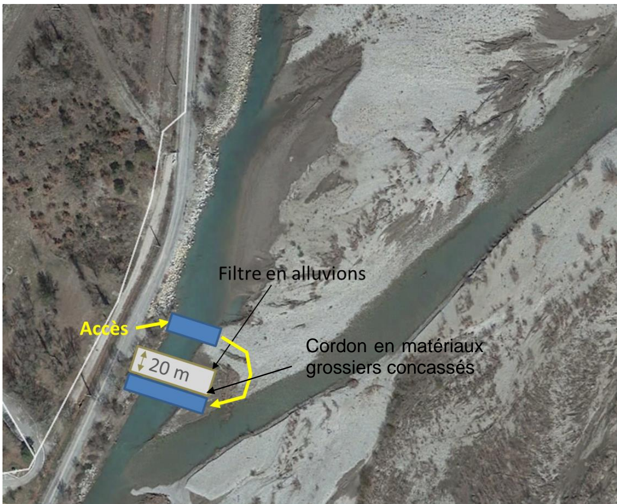
Figure 10 : Schéma du principe de confinement du chantier
