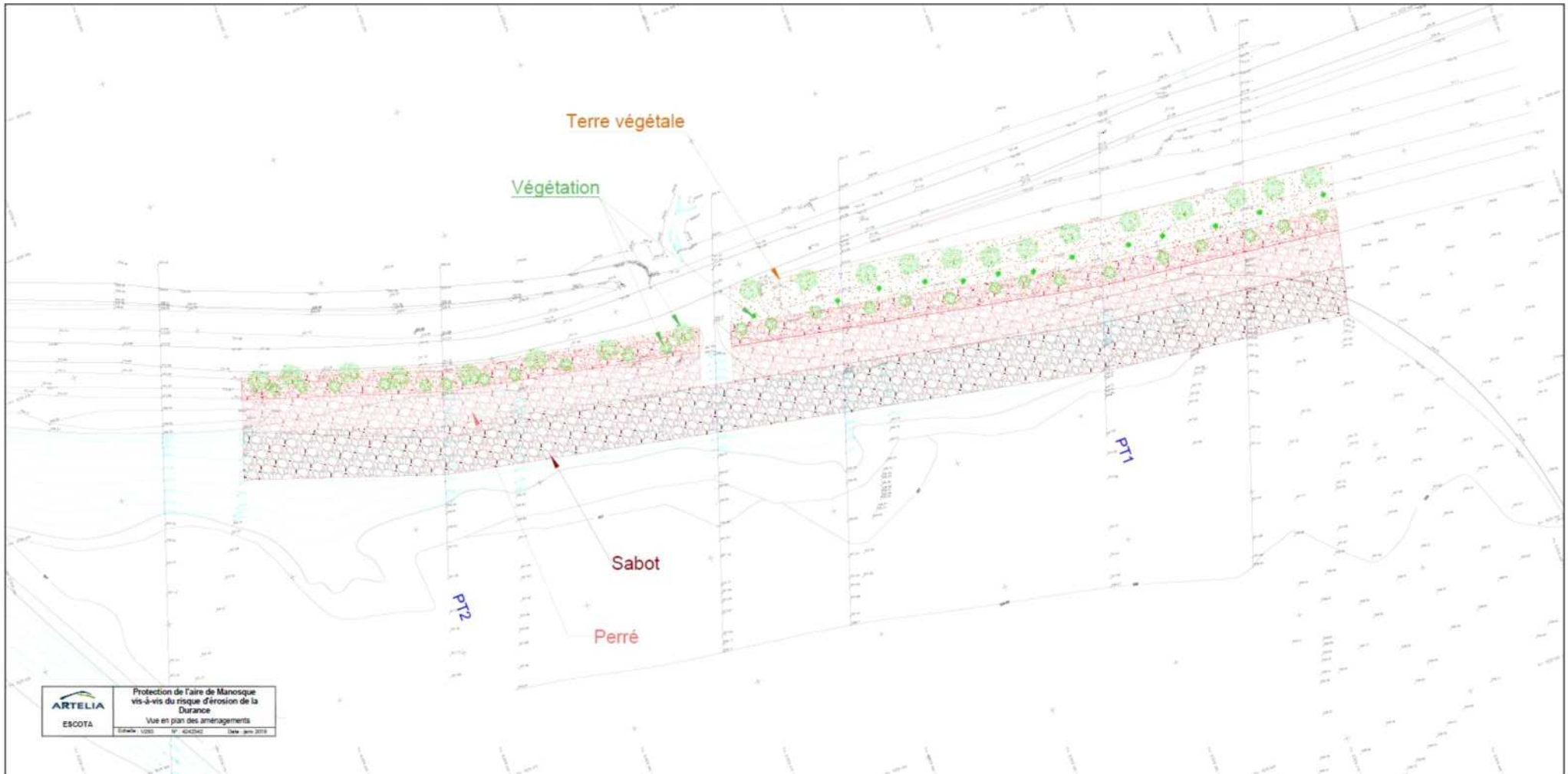
Figure 7 : Vue en plan des protections de berge après les travaux
