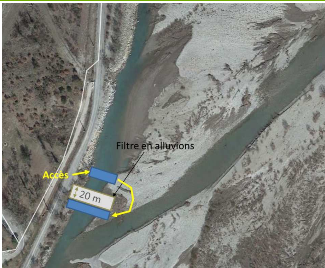
Figure 56 : Présentation de l'implantation du filtre de limitation des MES
