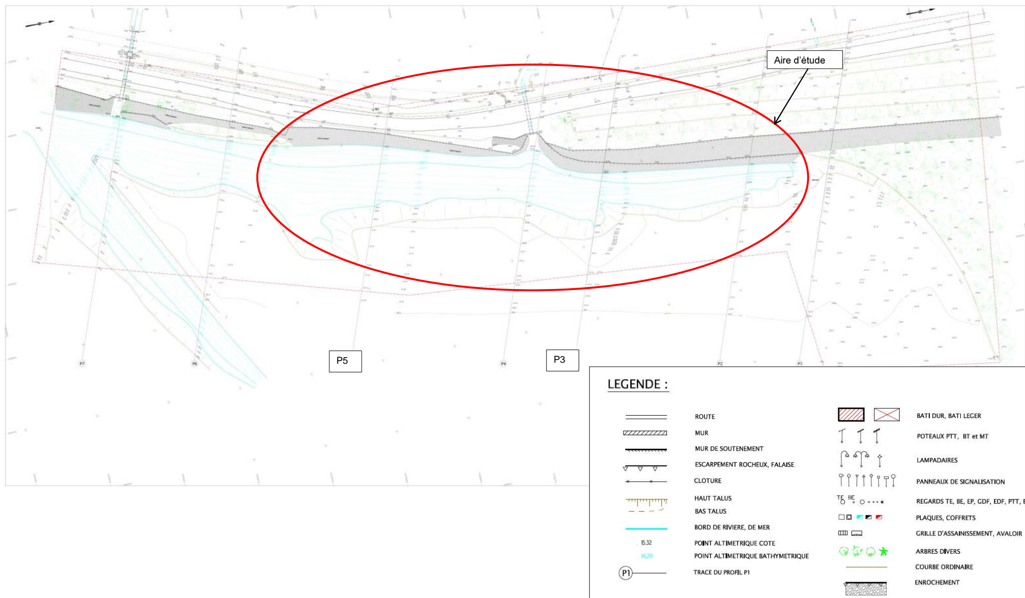
Figure 50 : Vue en plan de l'aire d'étude et localisation des profils en travers
