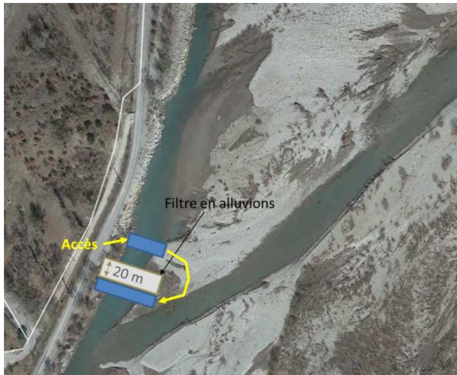
Figure 11 : Schéma du principe de confinement du chantier
