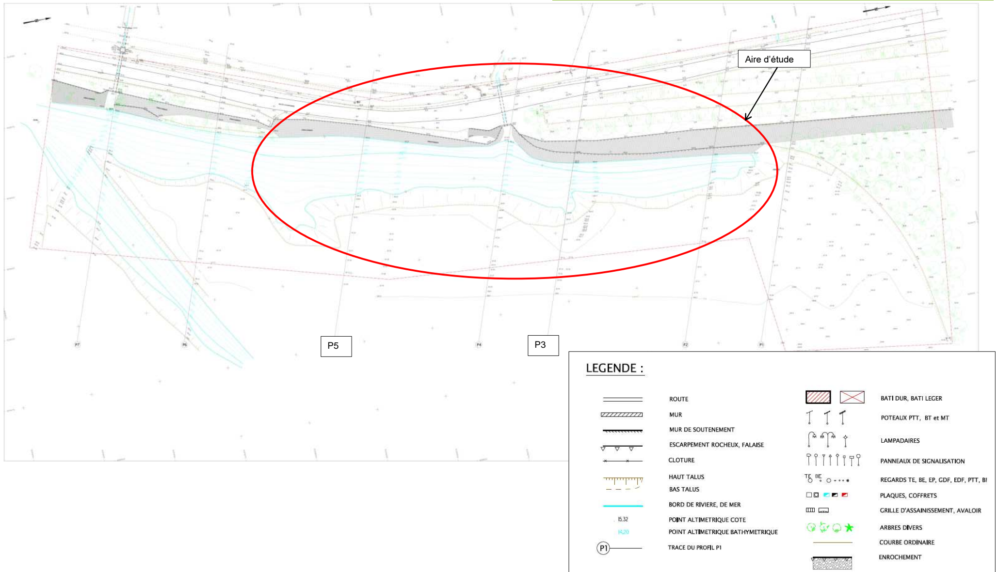
Figure 9 : Vue en plan de l'aire d'étude et localisation des profils en travers Source : Relevés topographiques et bathymétrique des berges réalisés par Opsia
