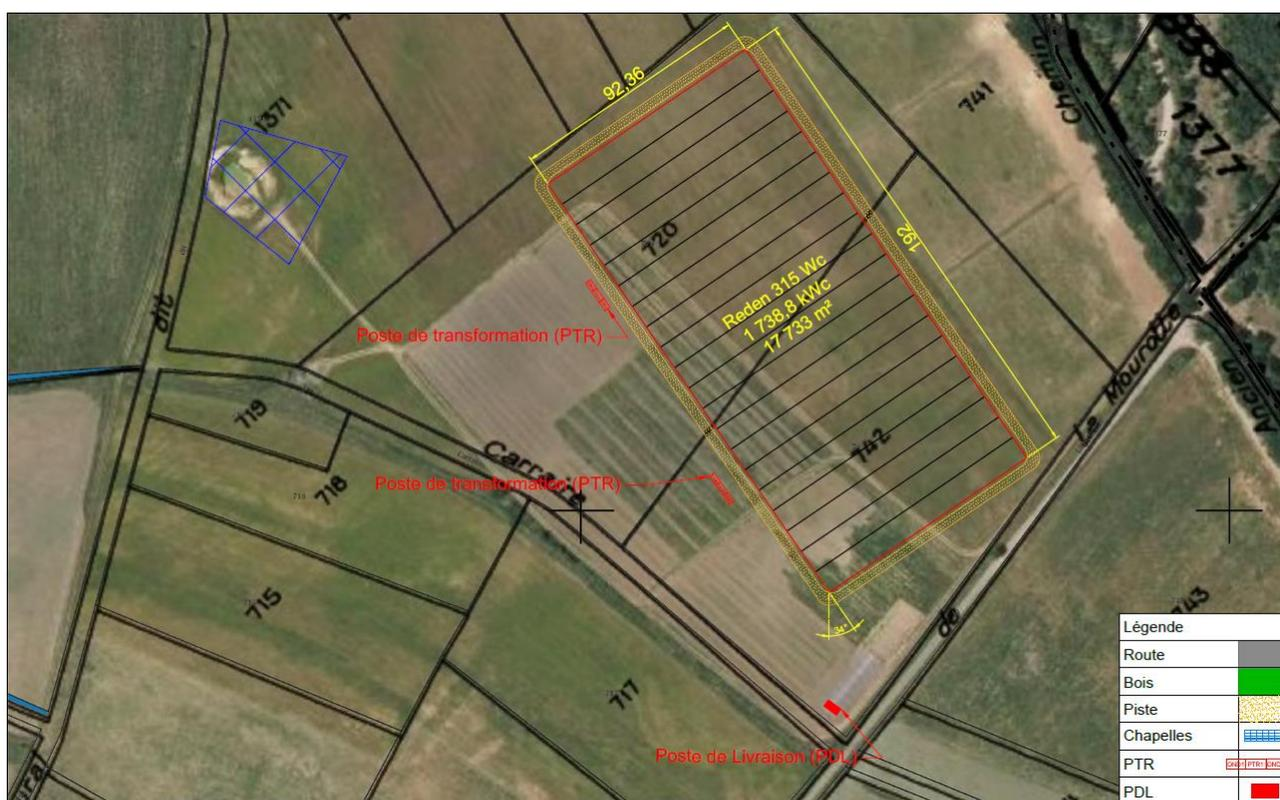
Figure 16 : Plan de masse du projet sur image satellite + cadastre
