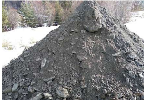
Photo des déblais issus du sondage n°4
