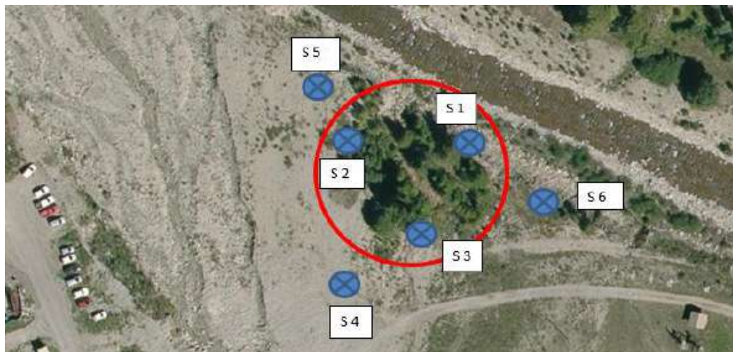
Localisation des sondages à la pelle mécanique – identification de la présence éventuelle d'une ancienne décharge
