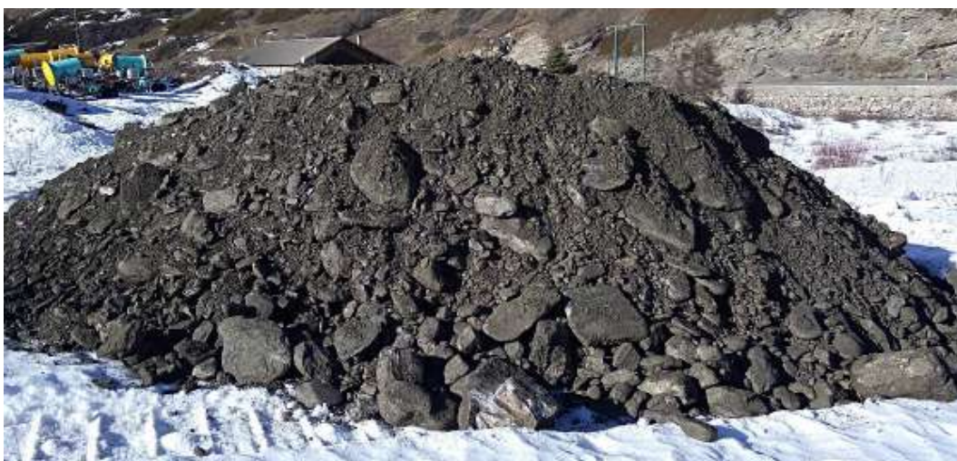
Photo des déblais issus du sondage n°4
