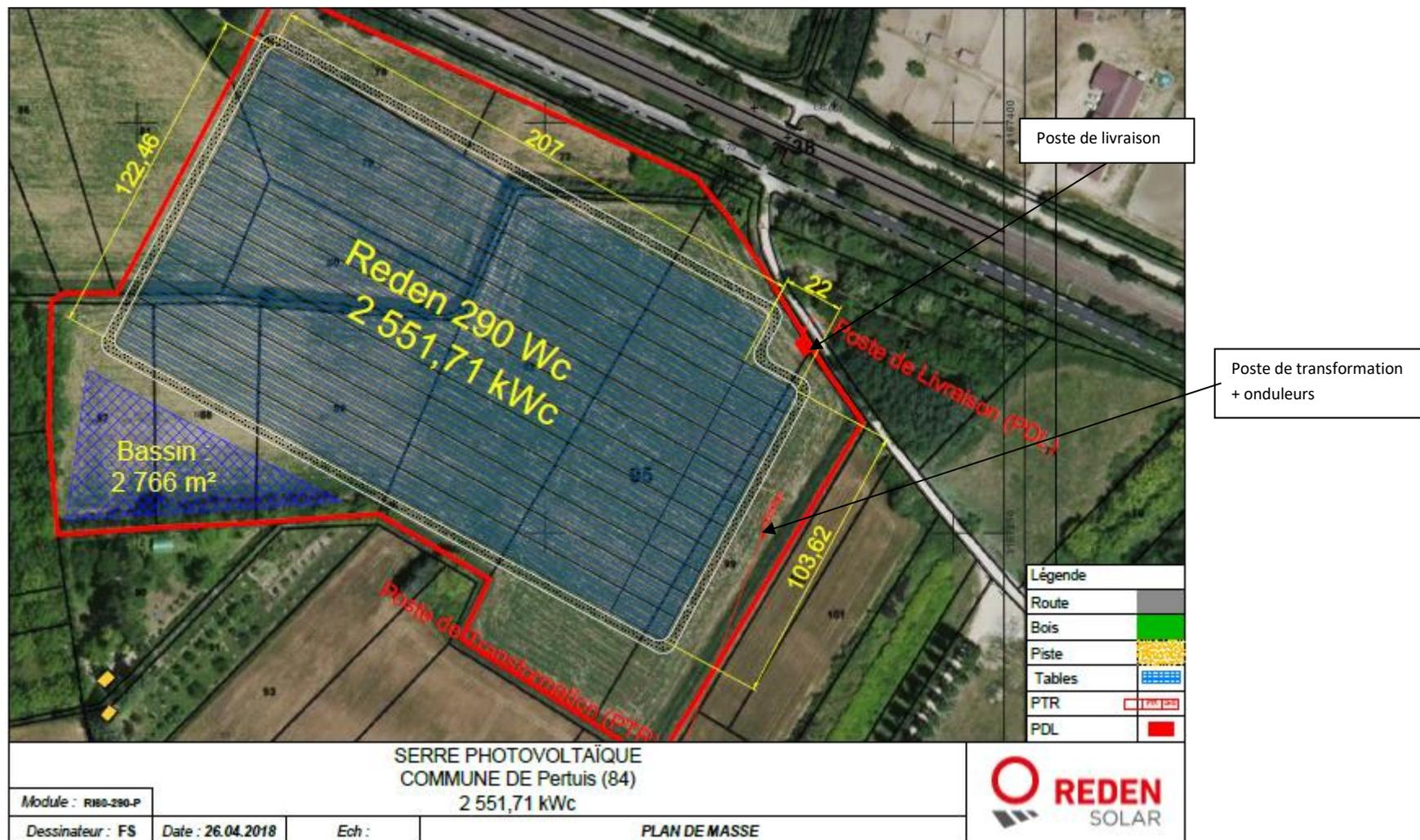
Figure 1 : Plan d'implantation des modules de la serre sur le site.
