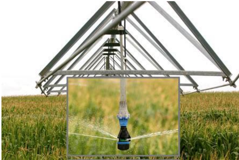
Figure 7 - Asperseur type, ici monté sur une rampe d'arrosage au-dessus d'un champ de maïs
