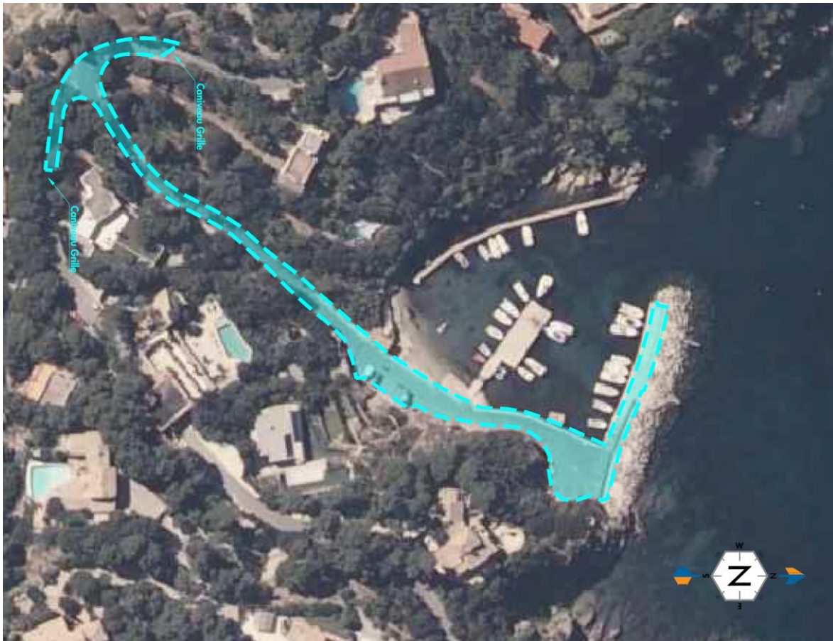
Figure 26 : Surface de ruissellement sur le parking du port
