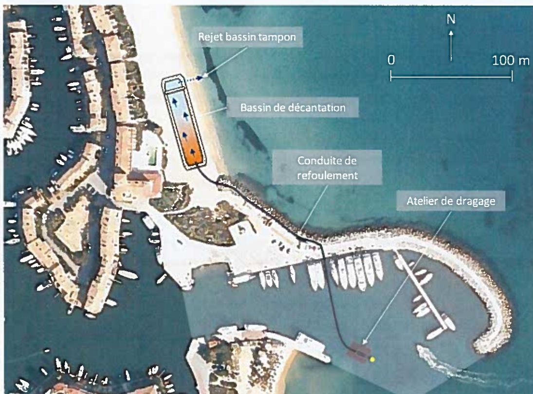
Zone de dragage (zone grise) et de décantation des sables dragués sur la plage
