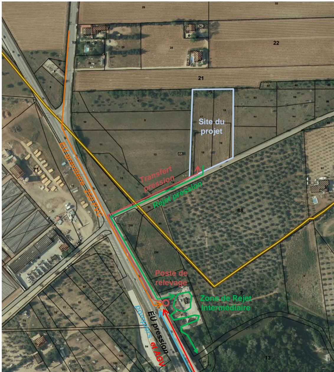
Fig. 34. Projet de raccordement de la future station
