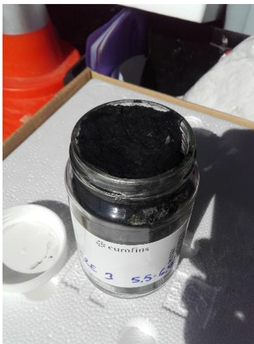
Photo 18 : Aspect des matériaux vers 5,5 m de profondeur
