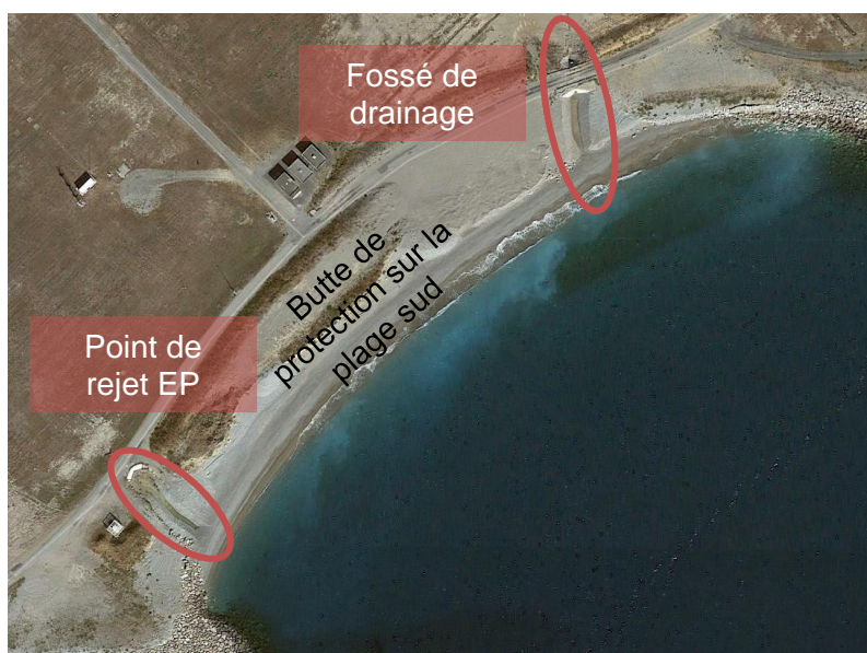
Figure 18 : Localisation des points de rejets des eaux pluviales de part et d'autre de la butte sur la plage sud
