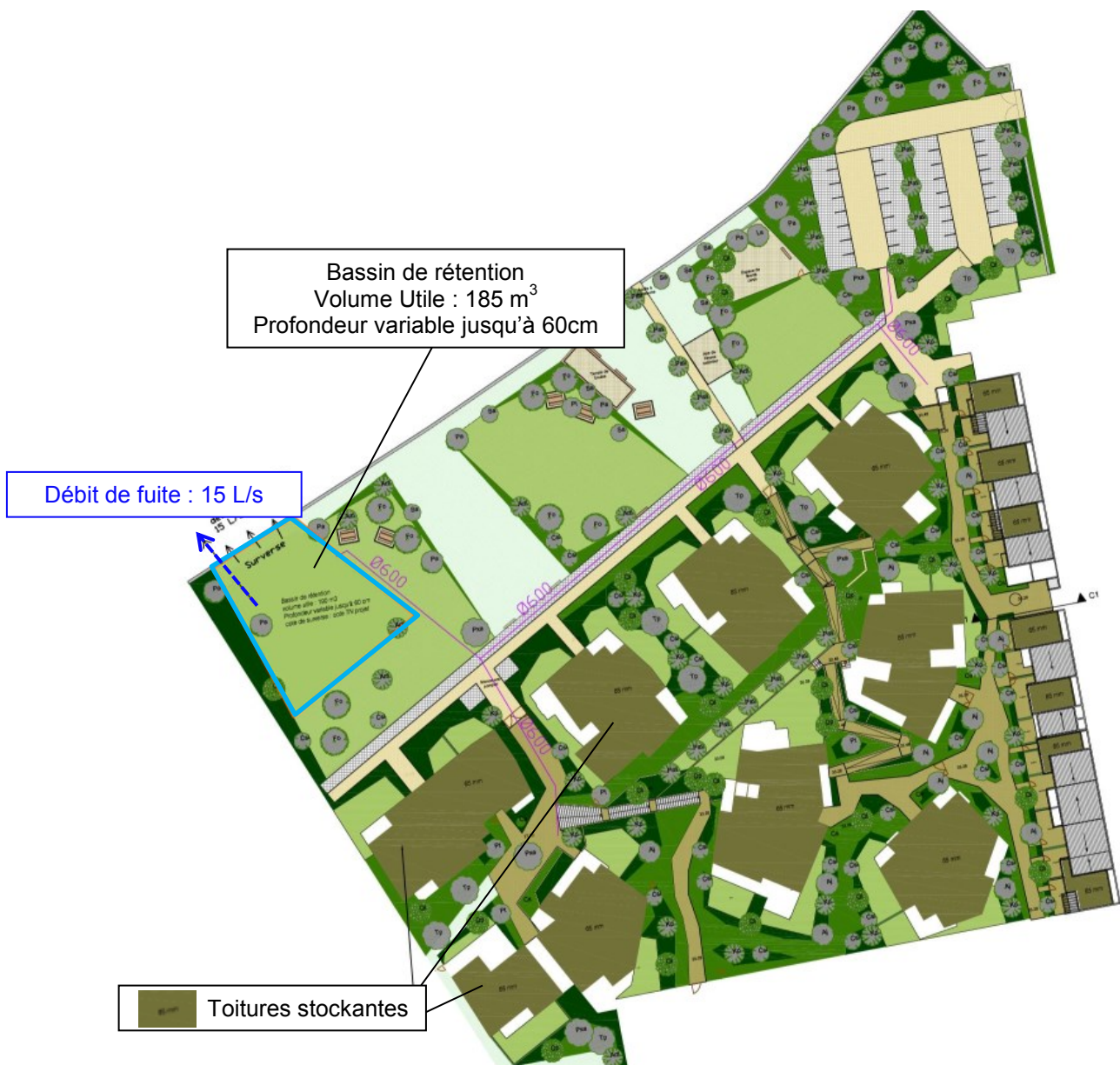
Fig. 7. Plan de localisation des aménagements hydrauliques
