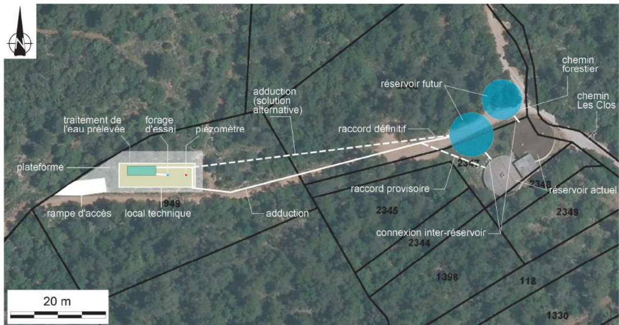
Figure 19. Plan schématique des installations projetées pour la mise en exploitation du forage des Clos
