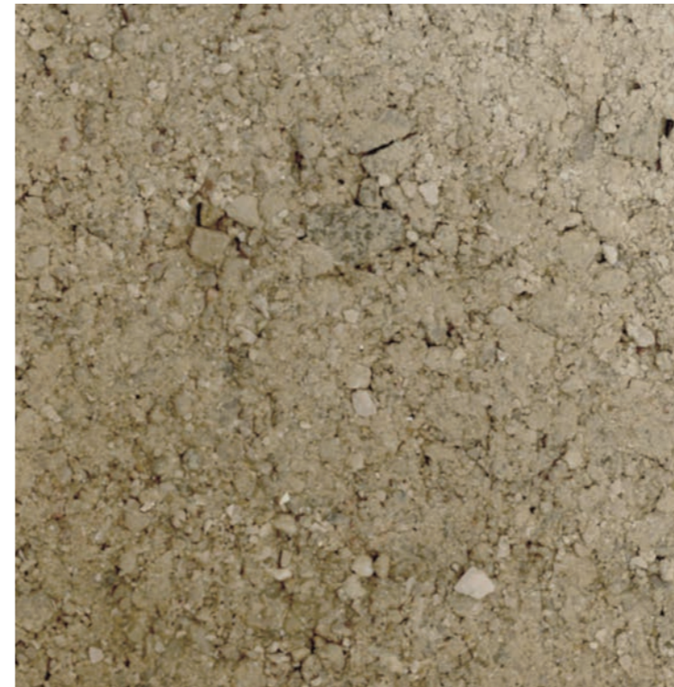
Chemin accessible PMR : stabilisé renforcé, teinte terre
