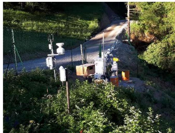
Photographie 27 : Système de surveillance du glissement de terrain
