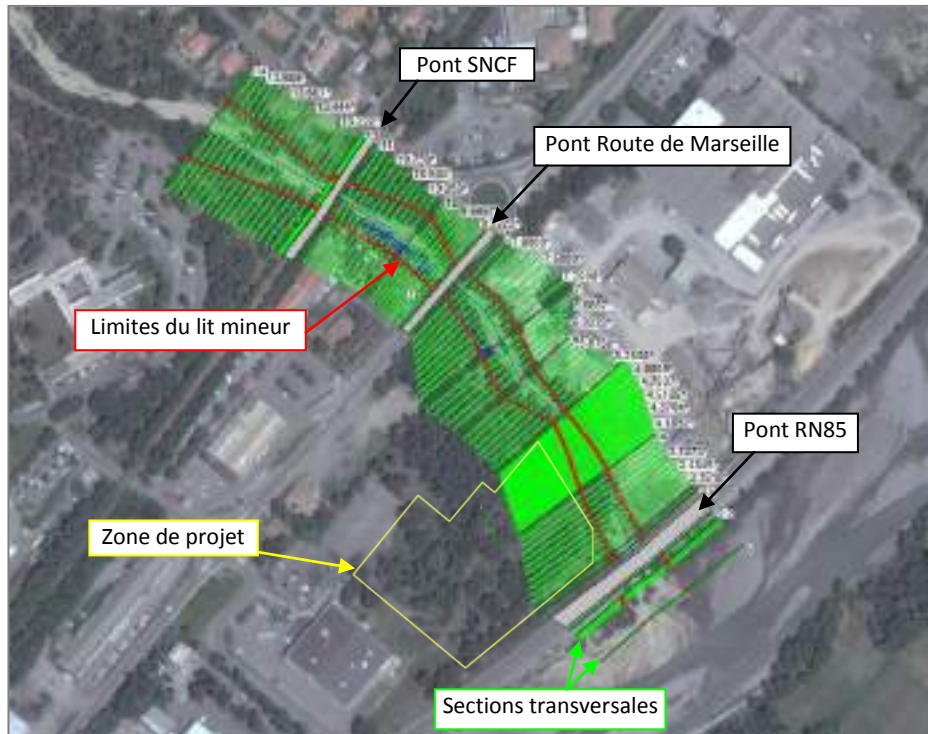
Construction du modèle 1D à partir du logiciel HEC-RAS sur fond de vue aérienne
