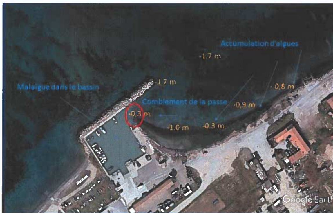
Figure 3 - Vue satellite de détail de la zone de projet avec la passe qui se comble régulièrement entourée de rouge (GoogleEarth modifié P2A)
