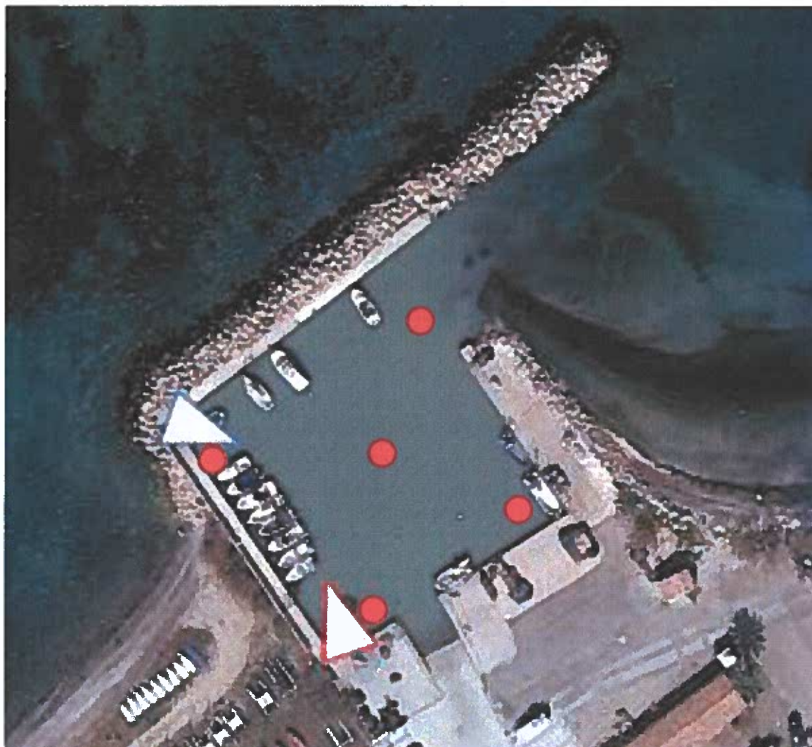
Figure 9. Répartition des dispositifs d'aérateurs/circulateurs (triangles rouge et bleu) et des points de contrôles à la sonde multiparamètres (cercles rouges)
