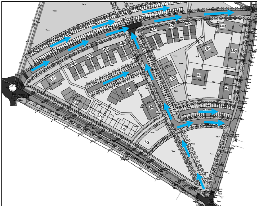
Cheminement des écoulements – Pluie exceptionnelle
