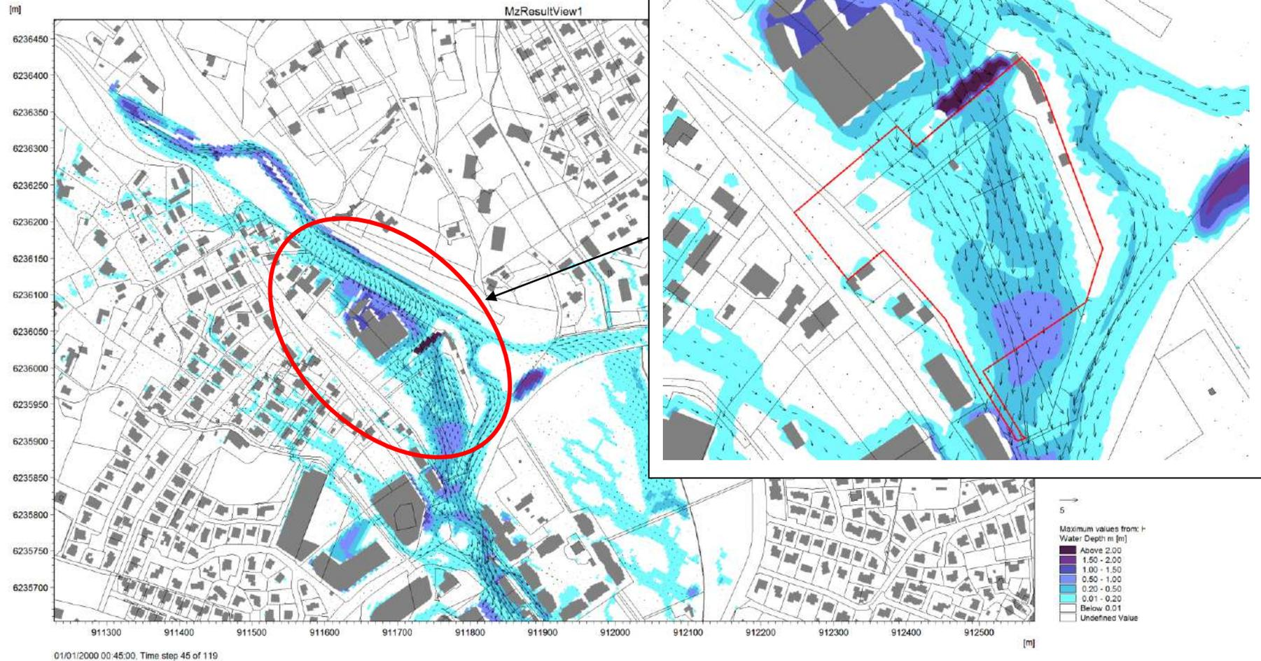
Figure 18 : Etat actuel – Dynamique des écoulements – Crue centennale
