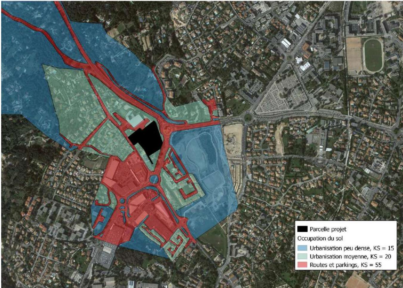
Figure 17 : Zonage du coefficient de Strickler sur la zone étudiée
