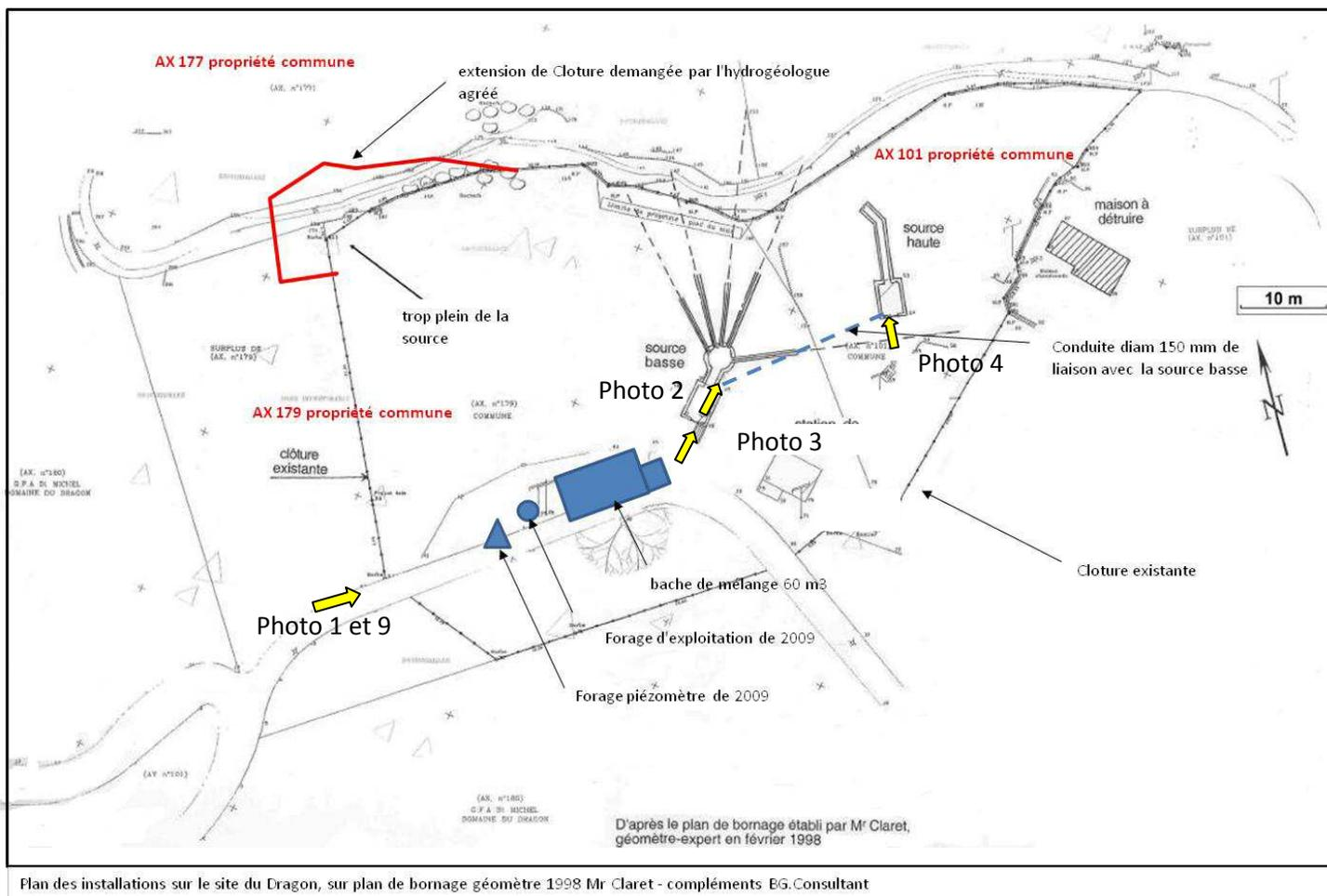
**FIGURE 1:** Situation des captages et des installations associées au sein du périmètre de Protection Immédiate déterminé par l'Hydrogéologue Agréé sur plan de bornage du géomètre.
