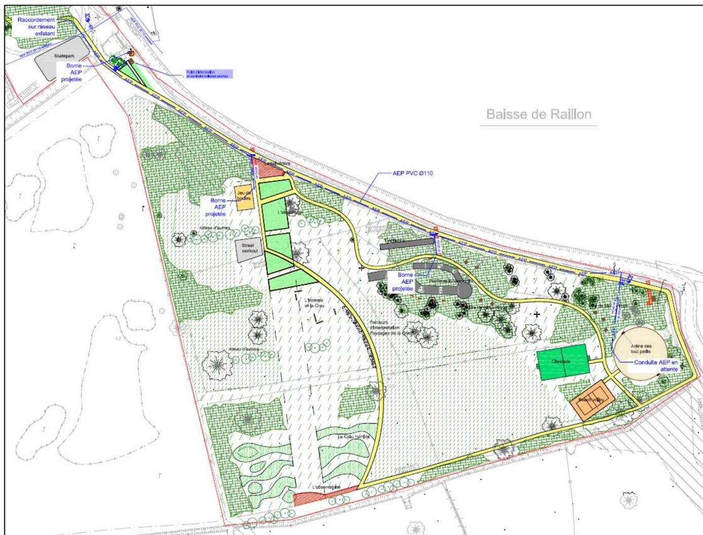
Illustration 5 : Plan des réseaux secs et humides projetés
