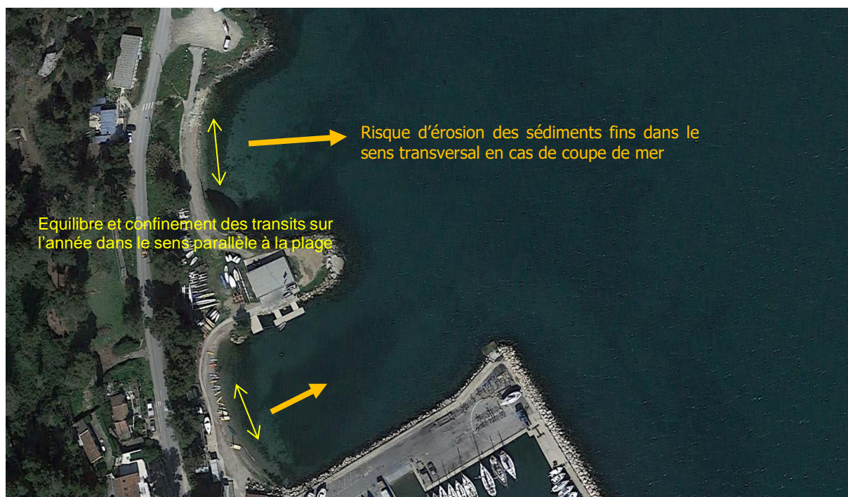
Schématisation des mouvements sédimentaires principaux dans les anses au Nord du port des Heures Claires
