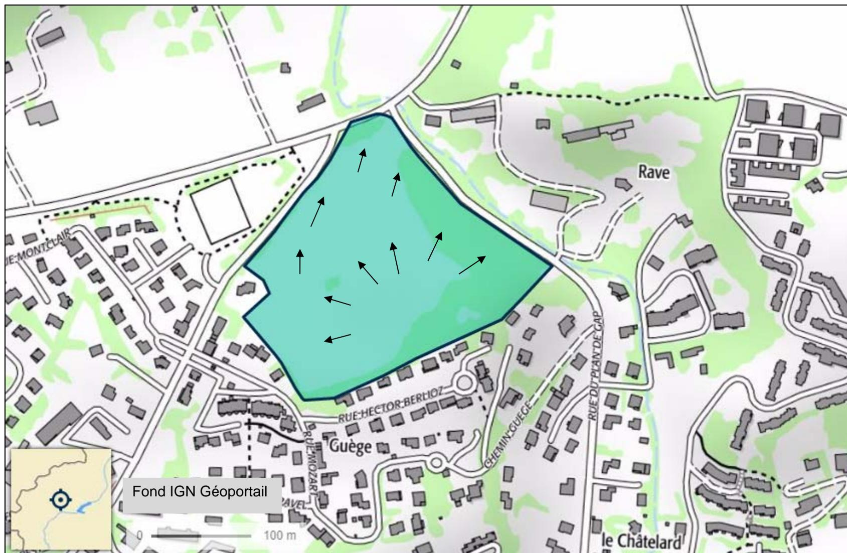
Figure 4 : Sens d'écoulement des eaux de ruissellement sur fond IGN au 1/5000°
