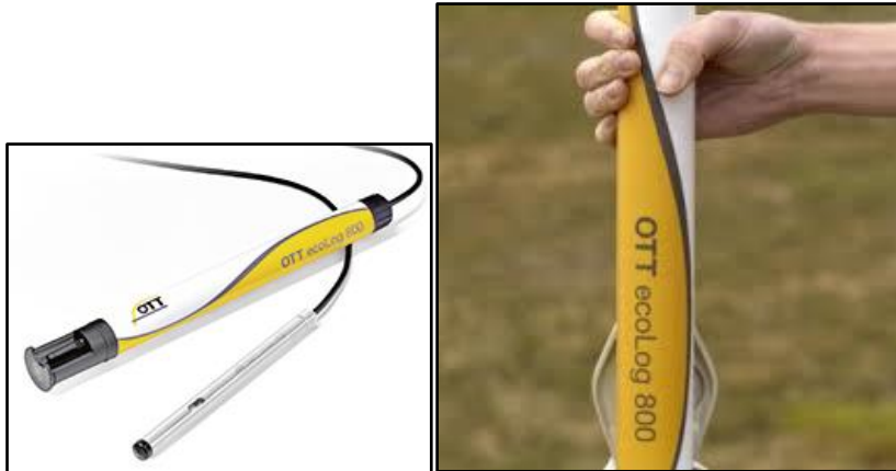
Illustration 50 - Installation d'une centrale Ecolog 800 (à gauche) sur un point (clichés OTT France).
