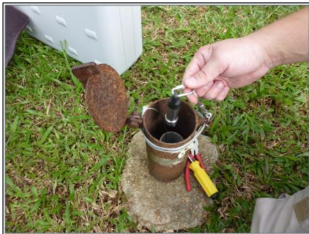
Illustration 48 - Installation d'un Diver sur un ouvrage (cliché BRGM).
