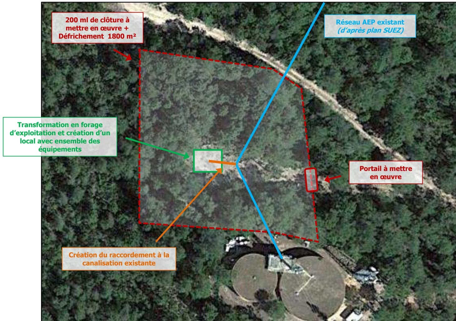
Figure 3 : Descriptif des travaux à réaliser dans le PPI
