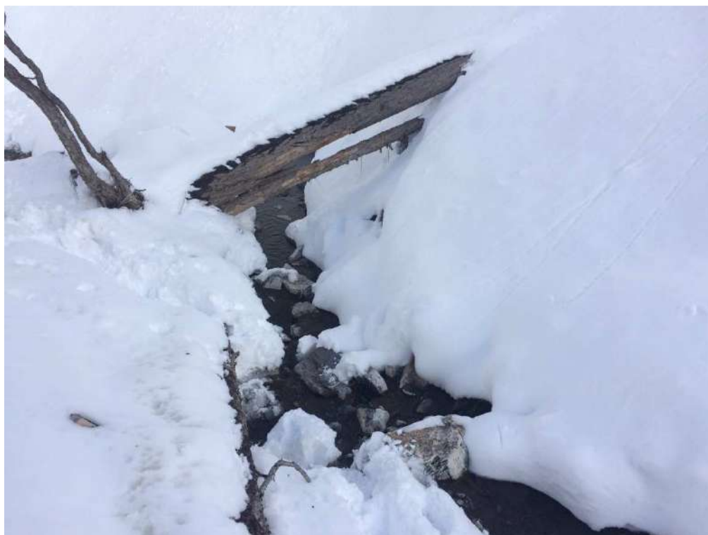
10 mars 2016 – débit observé au niveau du mélèze couché débit estimé entre 5 et 10 l/s
