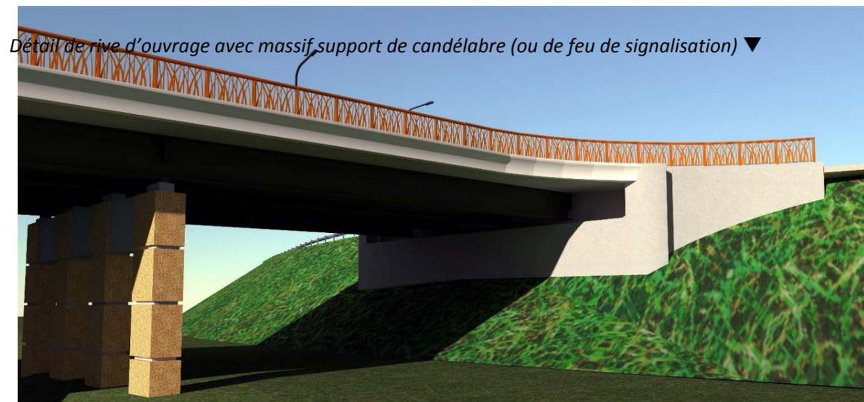
Détail de rive d'ouvrage avec massif support de candélabre (ou de feu de signalisation) ▼
