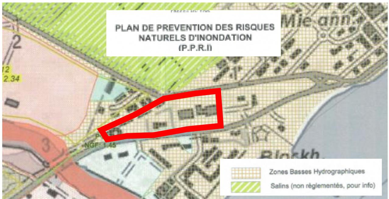
Les dispositions à respecter sont les suivantes : il convient de réaliser le plancher des parties aménageables ou habitables à une cote supérieure ou égale à : TN + 40 cm.
