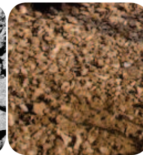
Mélange terre-pierre : 60% de granulats, 40% de terre
