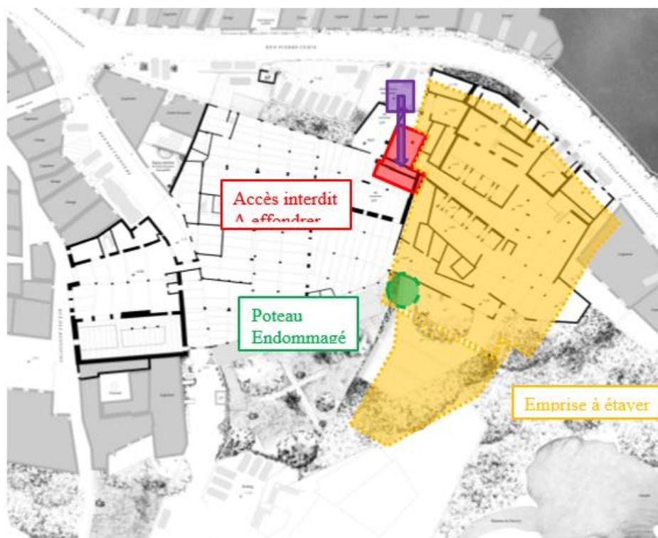
Figure 26 : Schéma général pour la mise en sécurité du reste du bâtiment - extrait du permis de démolir (ARTELIA, 2020)
