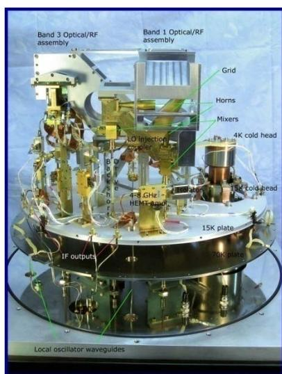
Figure 3 : Récepteur millimétrique produit par l'IRAM. L'ensemble est ensuite refroidi à des températures cryogéniques pour assurer un fonctionnement optimal et est installé au centre d'une antenne
